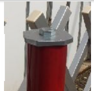
使用時は紛失防止で 単管ポールにフタをします
