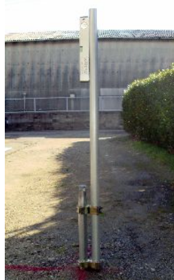
5. 単管の傾きの確認
